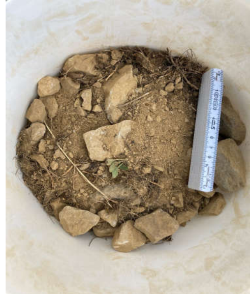
Bild 2: Materialmischprobe aus Beckensohle
