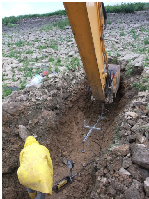
Bild 7.14 Ausführung der Plattendruckversuche in der wasserseitigen Böschung des Ringdamms
