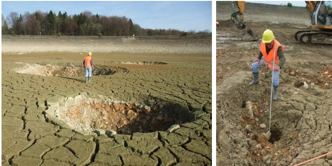
Bild 4.3: Einbrüche (im Vordergrund Einbruch 6) mit weitgehend runden Querschnitt (links) und Einbruch 8 (rechts) mit auffälliger Struktur
