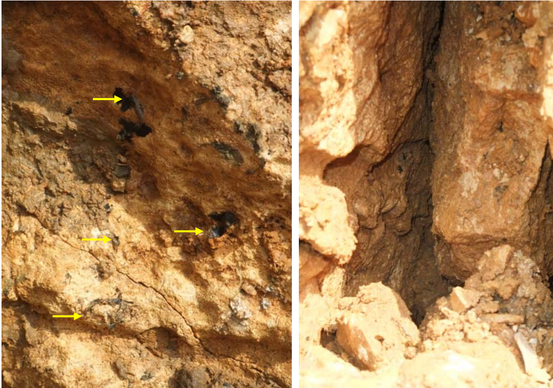
Bild 7.8 Schurf Einbruch 5: a. feuchte Kalksteinoberfläche mit anhaftenden schwarzen Pflanzenresten. b. Tiefe 2 m: Blick in offene Spalte der anstehenden Kalksteinformation
