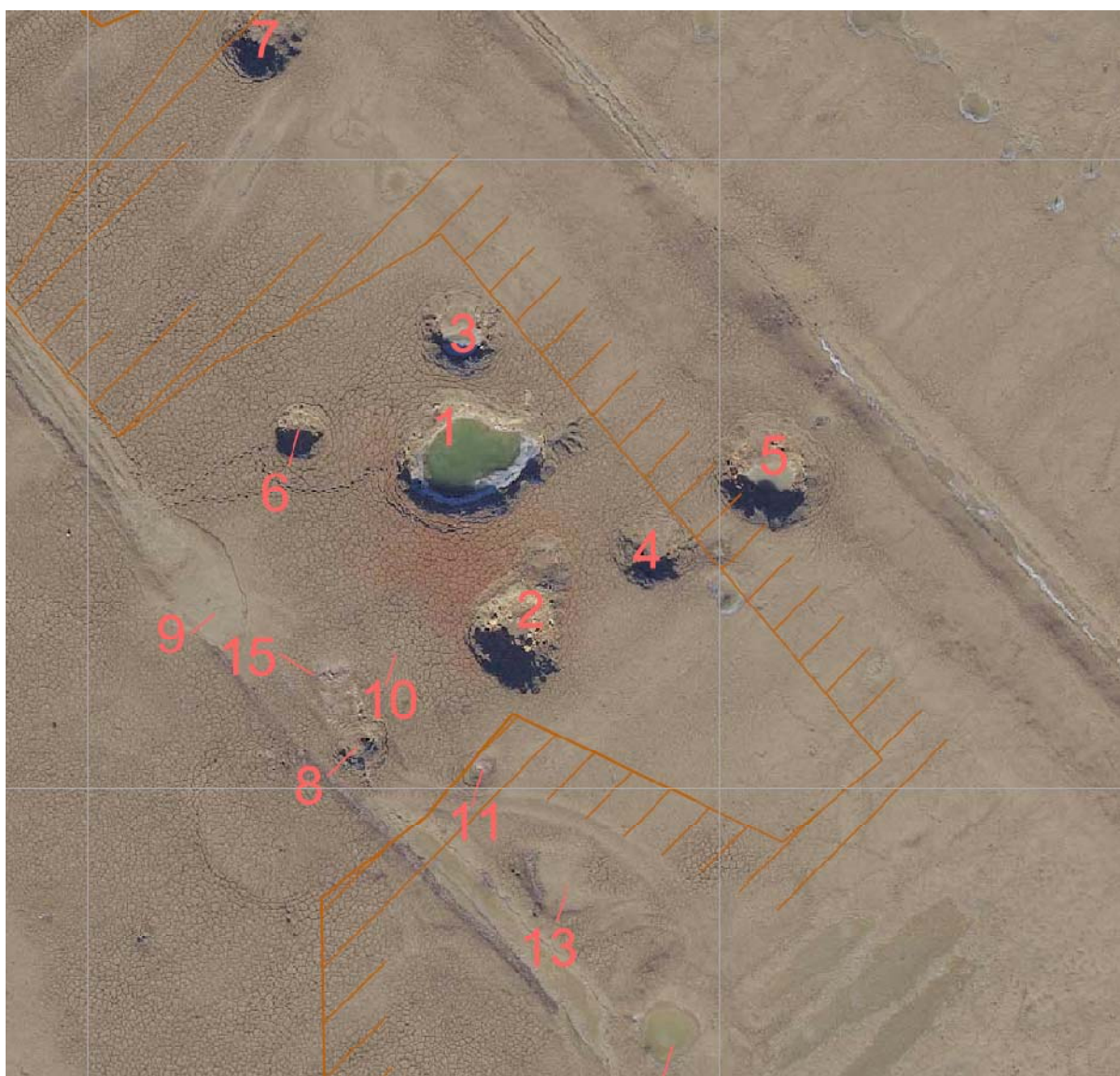
Bild 1: Luftbild der Einbrüche (Januar 2011)
