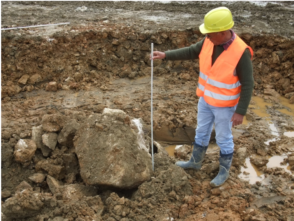
Bild 9: Block (Kantenlänge 70 cm) vermutlich aus Schutzschicht stammend im Einbruchtrichter
