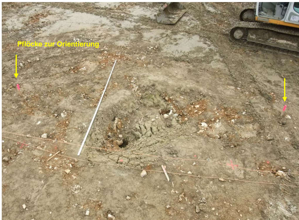
Bild 2: Blick von Nordwesten auf Einbruchtrichter vor Beginn der Schürfarbeiten, im Vordergrund Geoelektrischer Messquerschnitt E22
