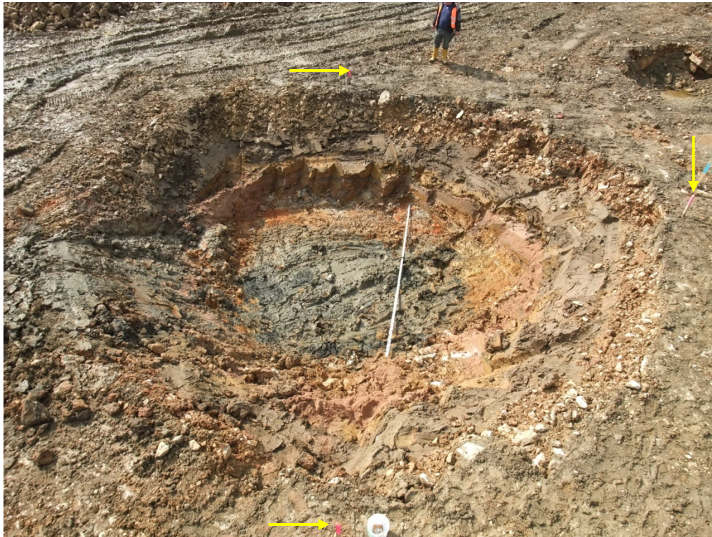
Bild 7: Blick von Nordwesten auf Einbruchtrichter 5 nach Abräumen der Sohldichtung und von ca. 0,5 m kreidezeitlichem Lockergestein
