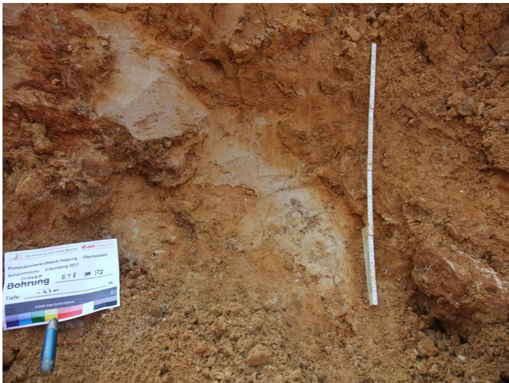
Bild 31: Aushub -4,7 m: kreidezeitliche Sande und Schluffe in östlicher Schurfwandung: hellgraue schlufffreie Sandader
