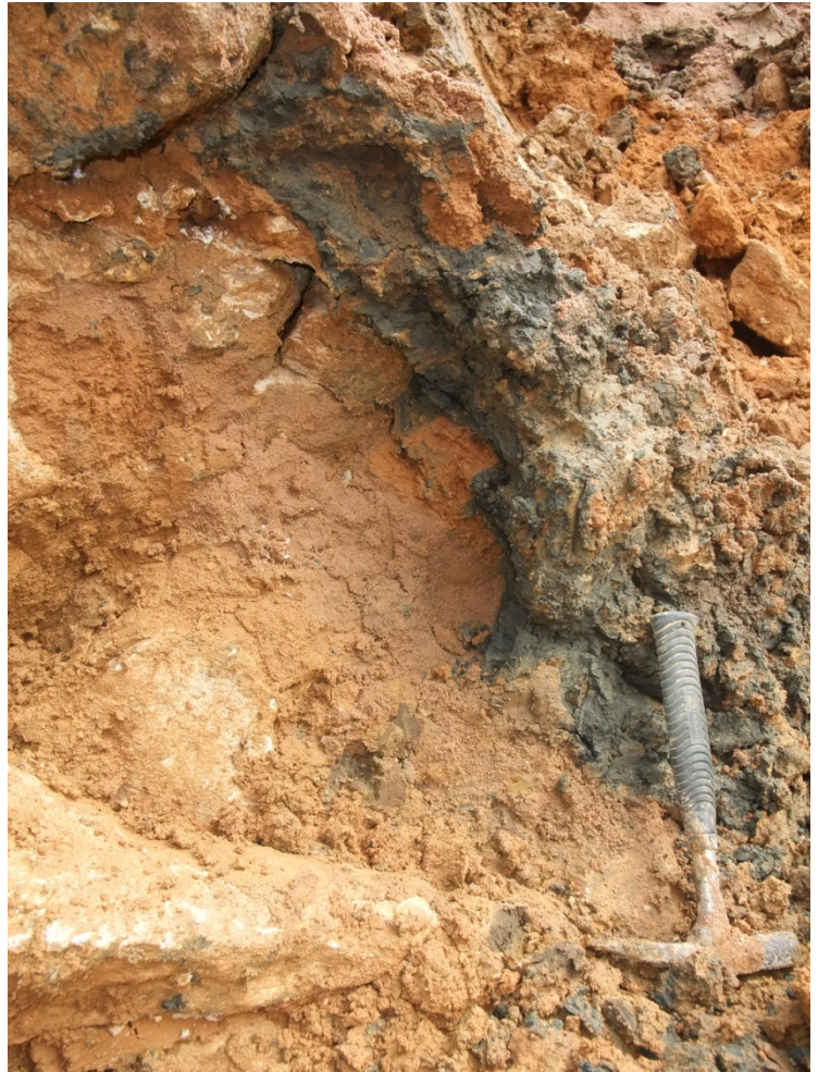
Bild 15: Aushubniveau -2,0 m: an Kalksteinoberfläche anhaftender Filtersand und dunkles weiches bindiges Material (Becken-sediment?)
