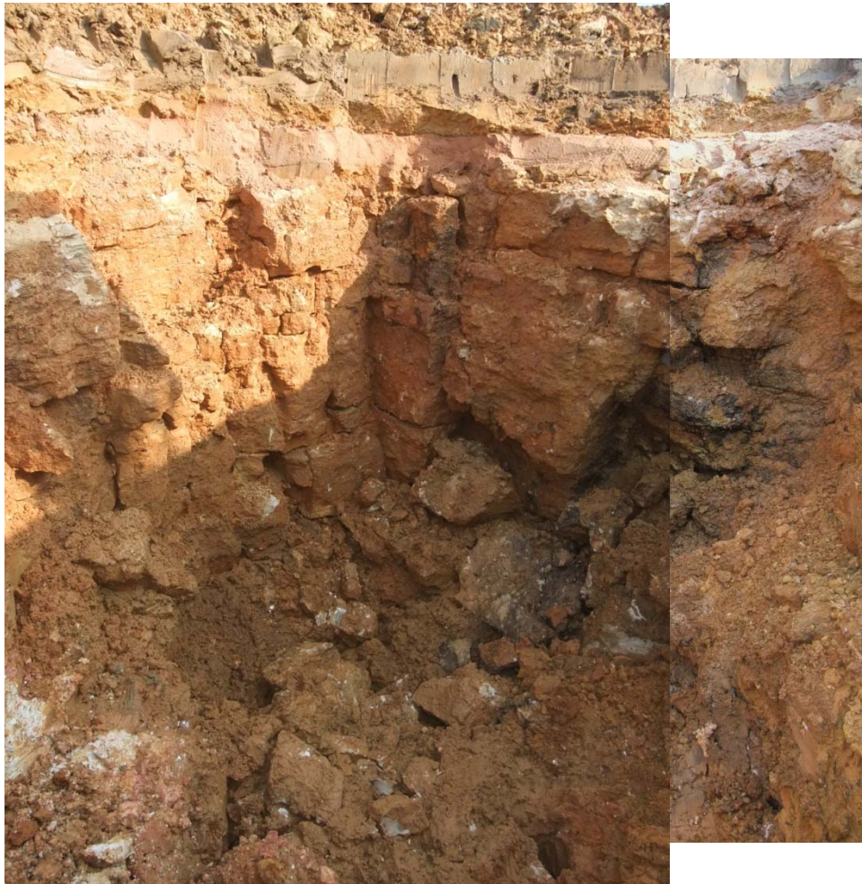
Bild 27: Blick nach Norden, Aushub -4,7 m, Kalksteinwand mit vertikalen Klüften (Kluftabstand im Mittel ca. 30 cm), tlw. schwarzer Kluftbesatz (Mangan)
