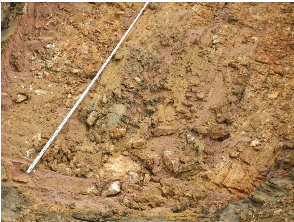
Bild 20: Detailaufnahme Einbruchtrichter nach Abräumen des Filtersandes (eingestürzte Schutzschicht, Filtersand, aber keine 'schwarzen Sedimente)
