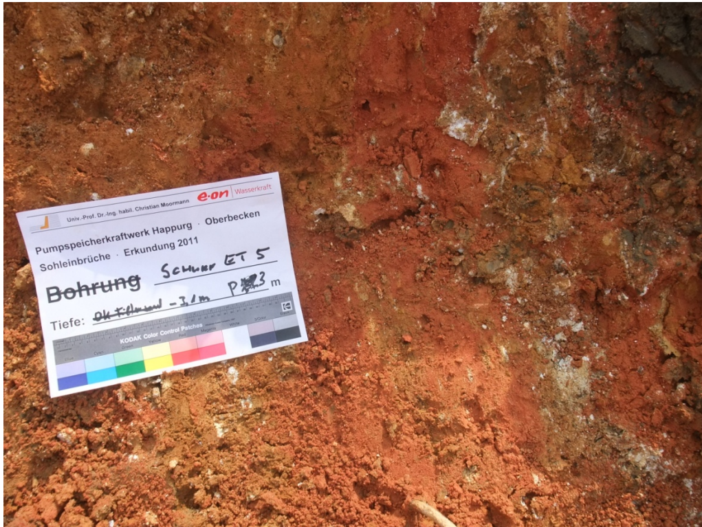
Bild 17: Aushub -3,1 m: an der östlichen Schluffwand anstehende sandige Schluffe und schluffige Sande rötlicher Färbung, bröckelig-trocken (bergfeucht)
