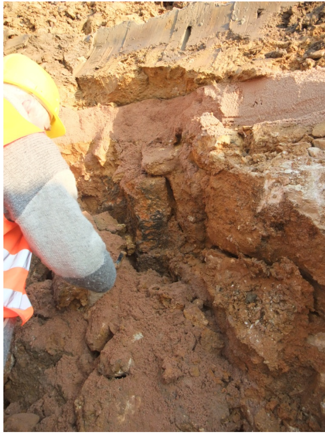
Bild 25: nördlicher Bereich: Filtersand lagert unmittelbar auf vertikal geklüfteten Kalkstein, schwarzer Kluft- besatz
