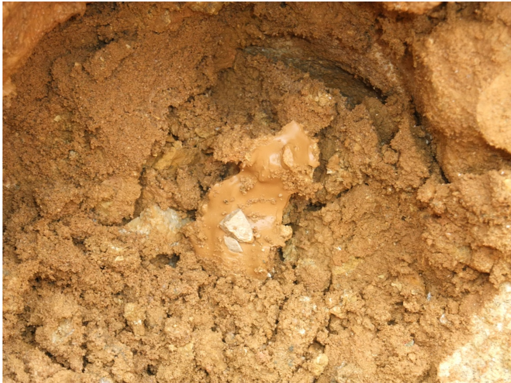
Bild 27: Aushub -5,3 m, Schurfwandung im Süden: dünnes 'Tonhäutchen' zwischen Sandlinse und Schluffsedimenten
