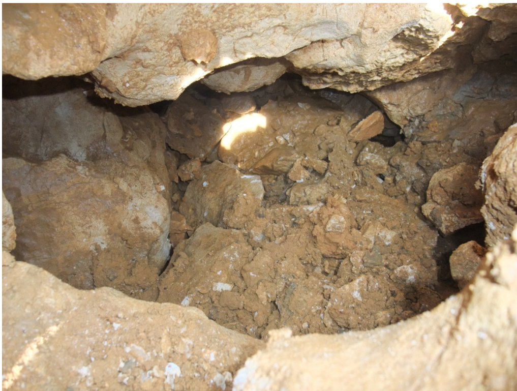
Bild 20: Blick in die offene Struktur (Bild 19), rd. 50 cm großer Hohlraum, an der Basis ein- getragenes Material
