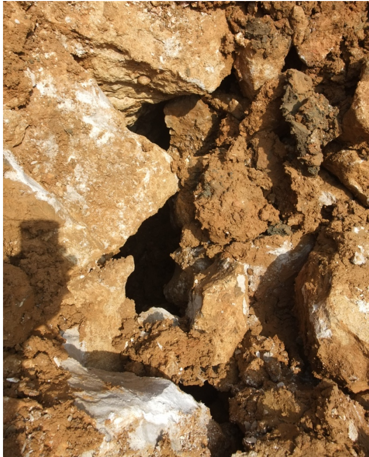
Bild 19: Aushub -5,0 m: offene Struktur (1,4 m hoch und 30 cm breit) in der im Norden des Schurfs anstehen- den Kalkstein- formation
