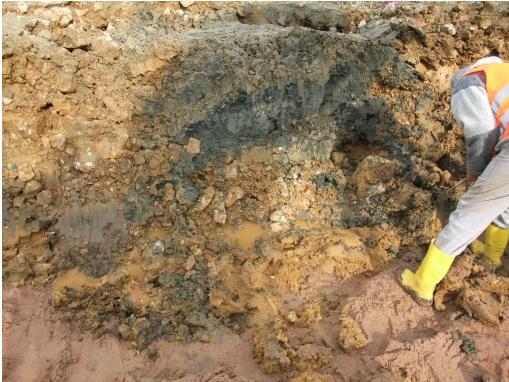
Bild 11: seitlich freigelegter Einbruchtrichter 17: abgesacktes schwarzes Beckensediment
