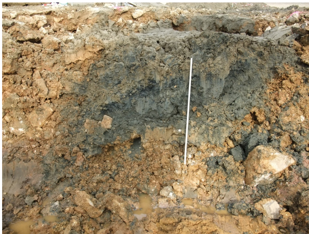
Bild 10: seitlich freigelegter Einbruchtrichter 17: abgesacktes schwarzes Beckensediment
