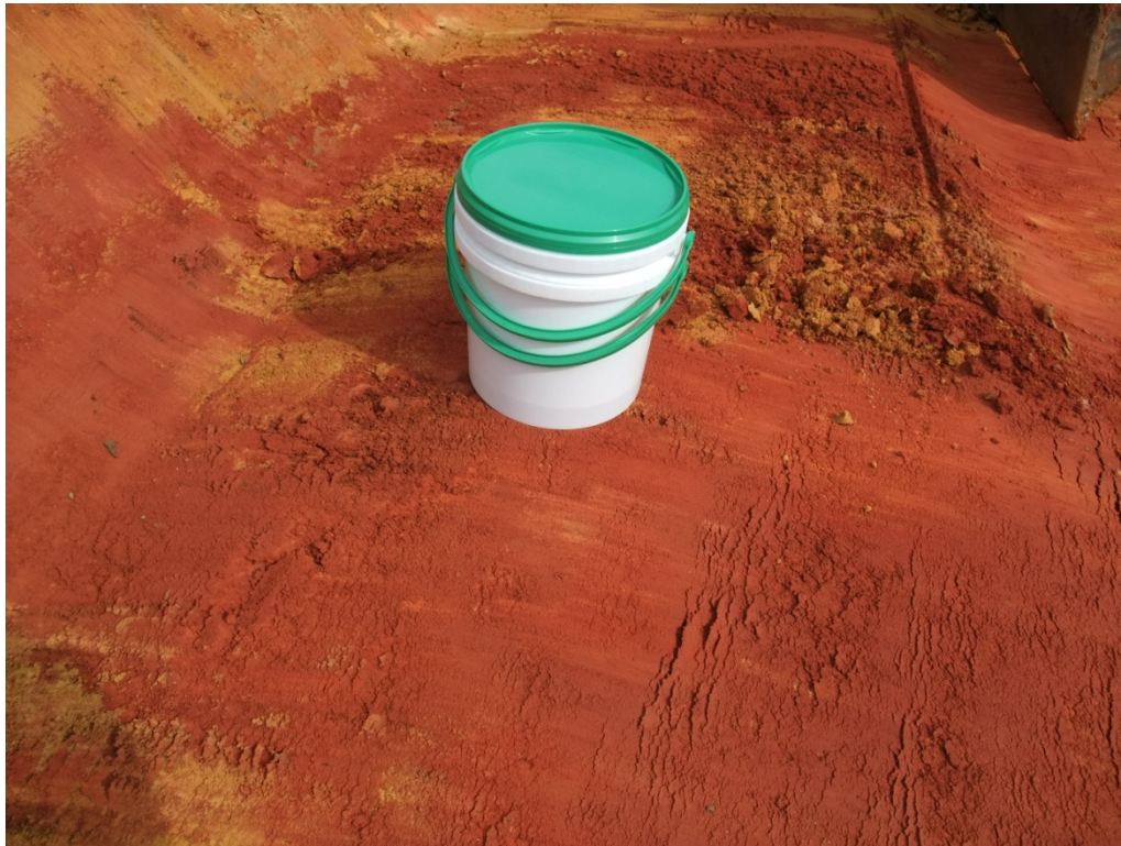
Bild 21: Aushub -1,9 m: kaminrote kreidezeitliche Sedimente (S,u´t), trocken-bröckelig
