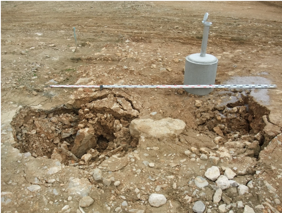
Bild 1: neue Einbruchtrichter rund um die Kernbohrung BK 34/2011 im Bereich des verfüllten Einbruchtrichters 7
