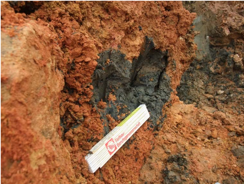
Bild 31: Aushub aus dem Schurf am Einbruch 2: schwarzes bindiges organisches Material und rötlich braune schluffige (Kreide-)Sande
