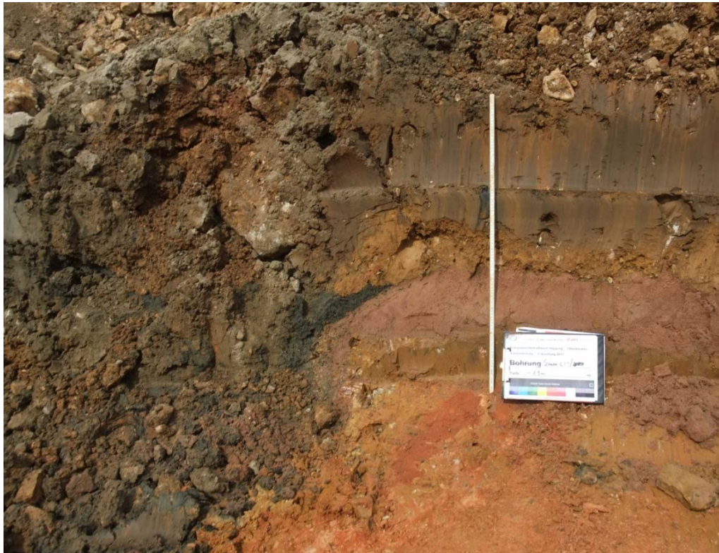
Bild 27: Aushub -1,9 m, Einbruchtrichter 3: nördlicher Rand des Einbruchtrichters
