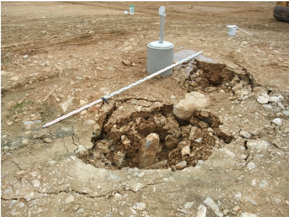
Bild 2: neue Einbruchtrichter rund um die Kernbohrung BK 34/2011 im Bereich des verfüllten Einbruchtrichters 7
