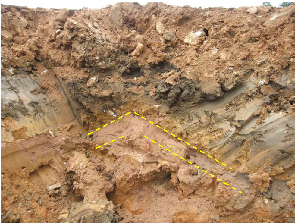
Bild 22: (deformierte?) Dränageschicht nordöstlich des Einbruchs 4 mit auffälligem „Dachprofil“
