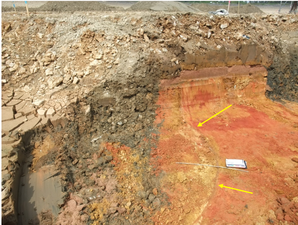
Bild 37: Aushub -2,3 m, nördlicher Rand Einbruchtrichter 1: Staffelbruch mit weiterhin mit Sand verfüllter Spalte
