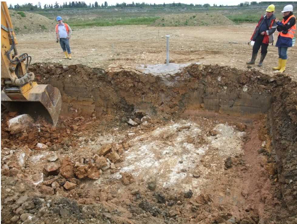
Bild 8: Freilegung Einbruchtrichter 7 (Mitte): Im Osten (rechts) anstehender Kalkstein, im Westen (links) Lockergestein mit eingelagerten Kalksteinblöcken
