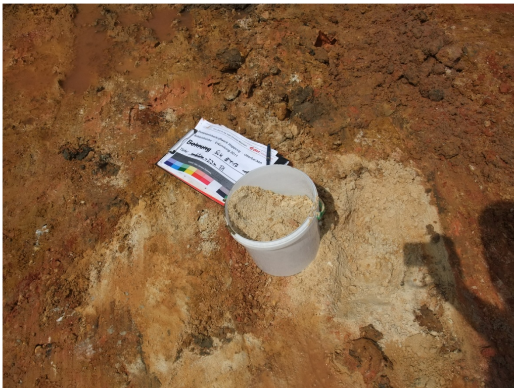
Bild 38: Aushub -2,3 m, außerhalb Einbruchtrichter 3: vereinzelt in den kreidezeitlichen Sedimente eingelagerte reine Sandlinsen
