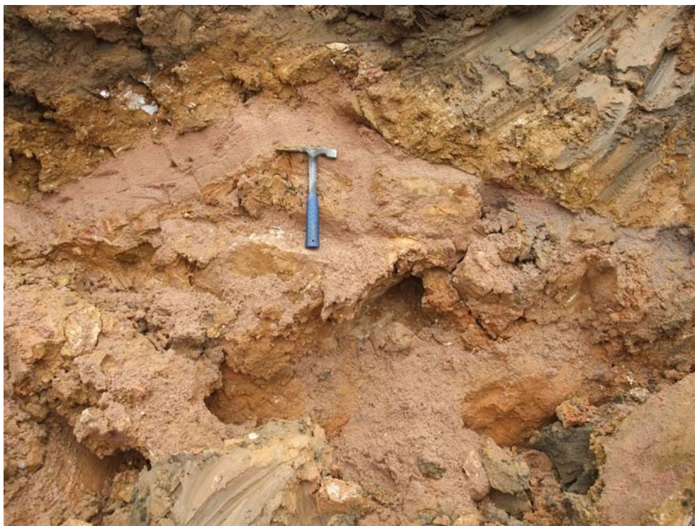
Bild 23: (deformierte?) Dränageschicht nordöstlich des Einbruchs 4 mit auffälligem „Dachprofil“
