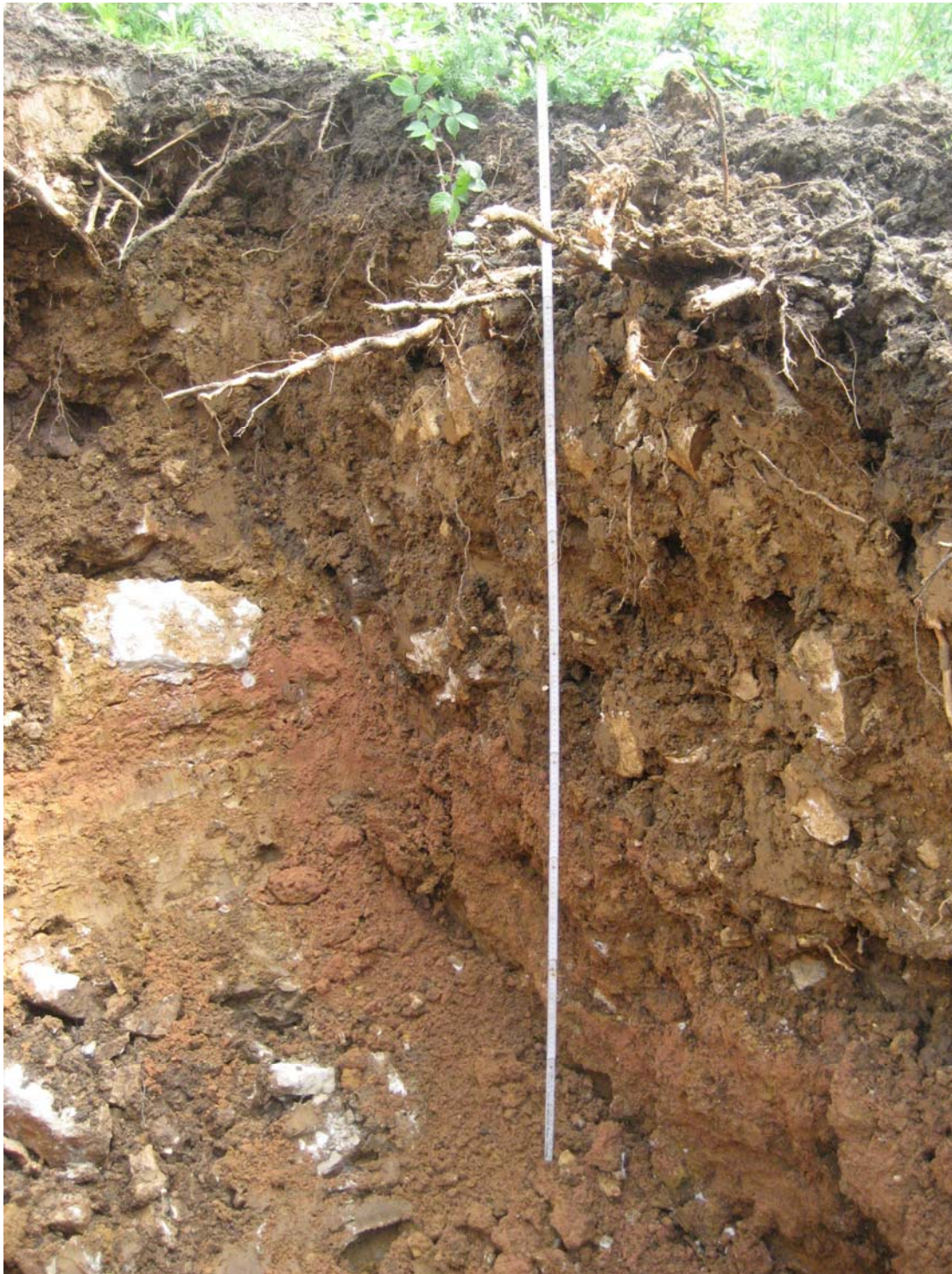
Bild 3: Aushubtiefe Schurf Nr. 02 bei ca. 2,0 m (aufgenommen am 15.08.2011)
