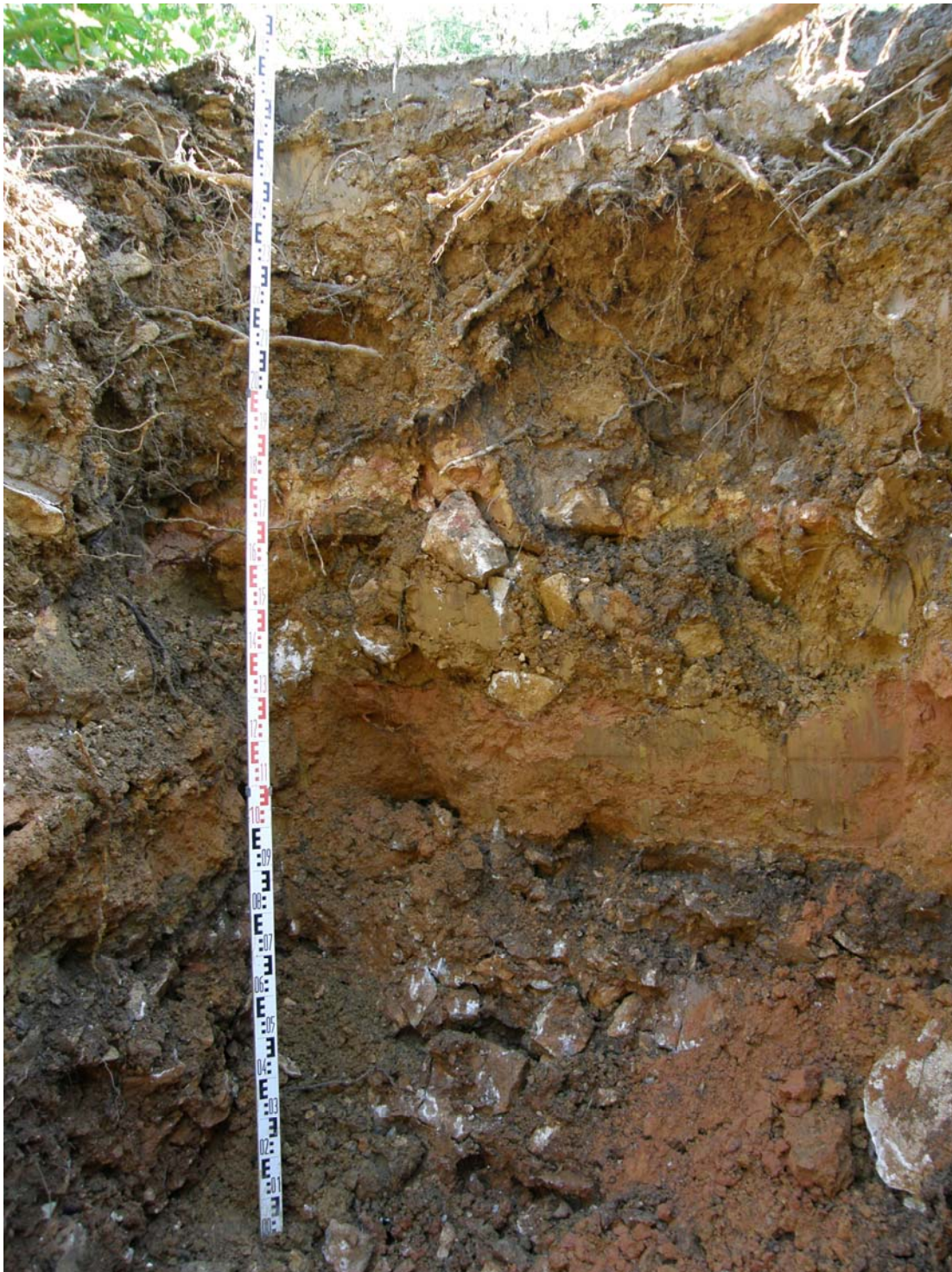
Bild 4: Aushubtiefe Schurf Nr. 02 bei ca. 2,9 m (aufgenommen am 17.08.2011)
