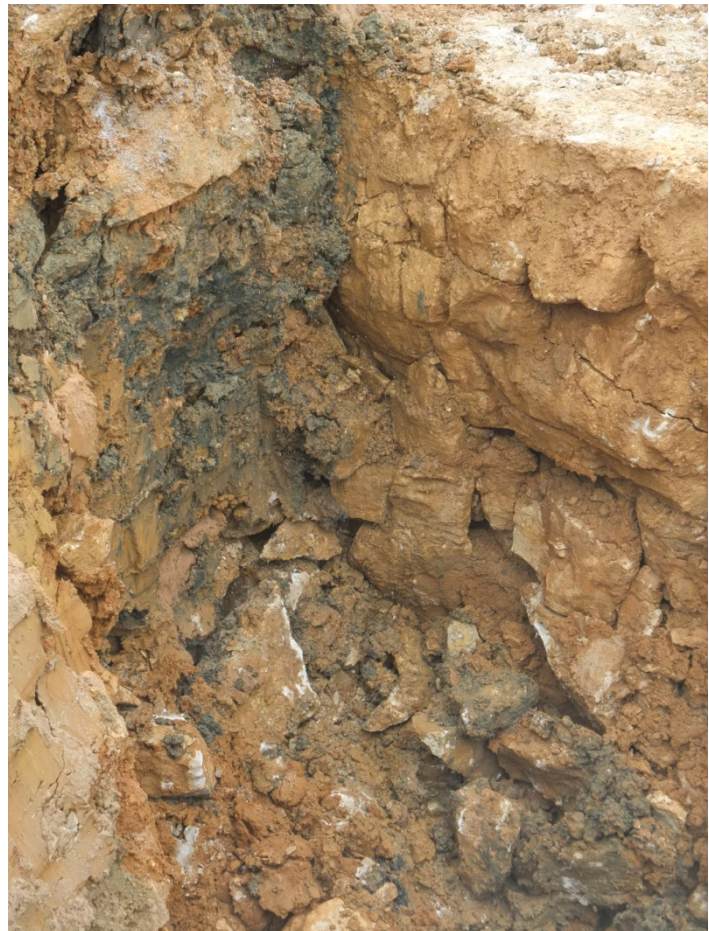
Bild 13: geklüftete Kalksteinformation im Osten des Schurfs, rechts im Bild das dunkle Material im Einbruchtrichter
