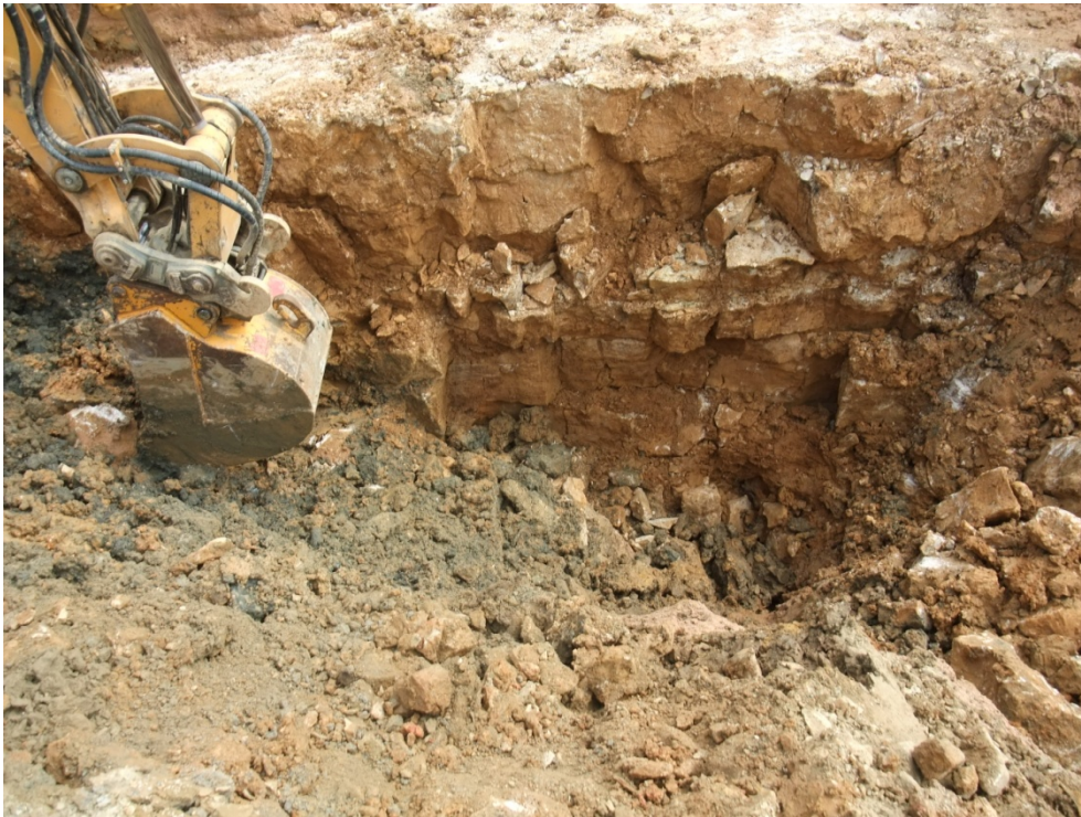
Bild 20: Verlängerung des Schurfs nach Norden: dunkles Material im Einsturztrichter im direkten Kontakt zu geklüfteten Kalkstein
