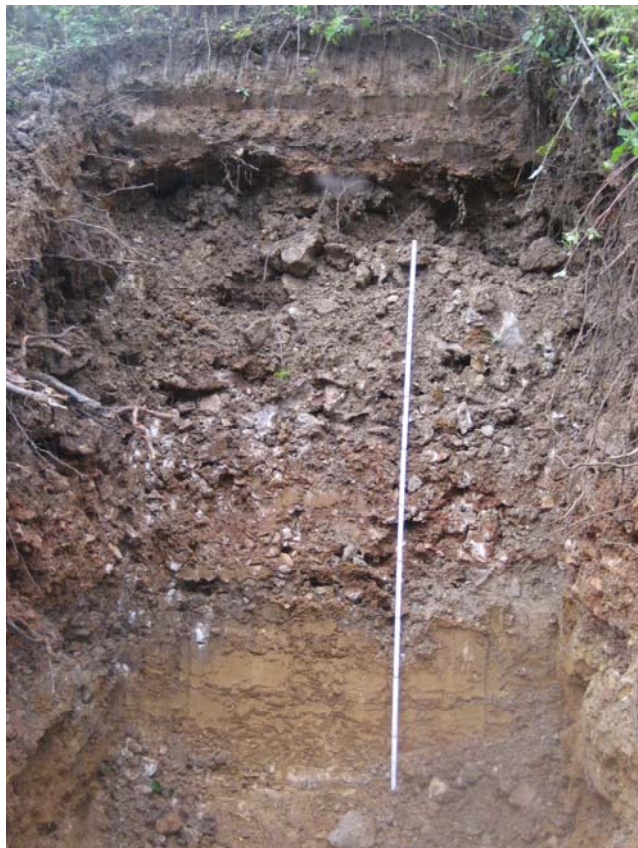
Bild 4: Aushubtiefe Schurf Nr. 01 bei ca. 2,5 m (aufgenommen am 15.08.2011)
