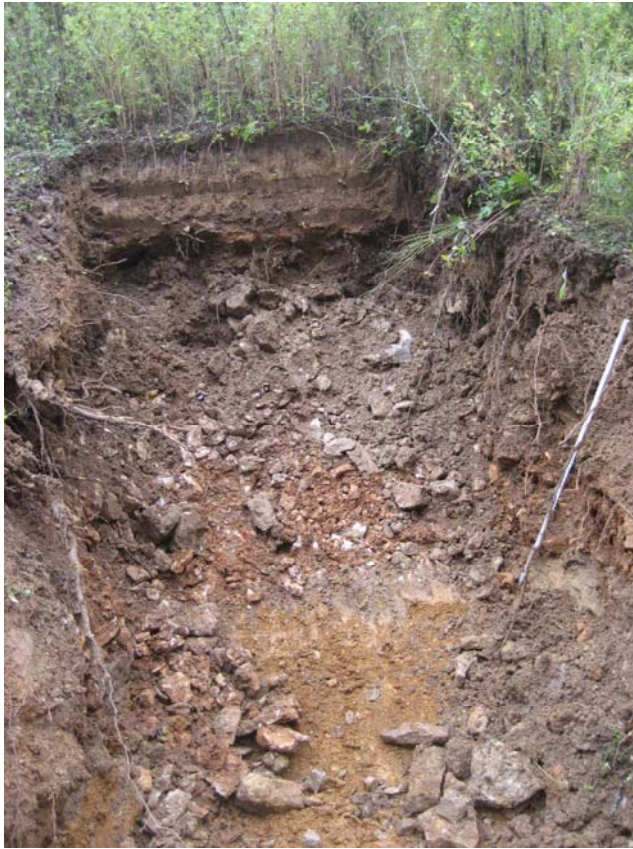
Bild 3: Aushubtiefe Schurf Nr. 01 bei ca. 1,0 m (aufgenommen am 15.08.2011)
