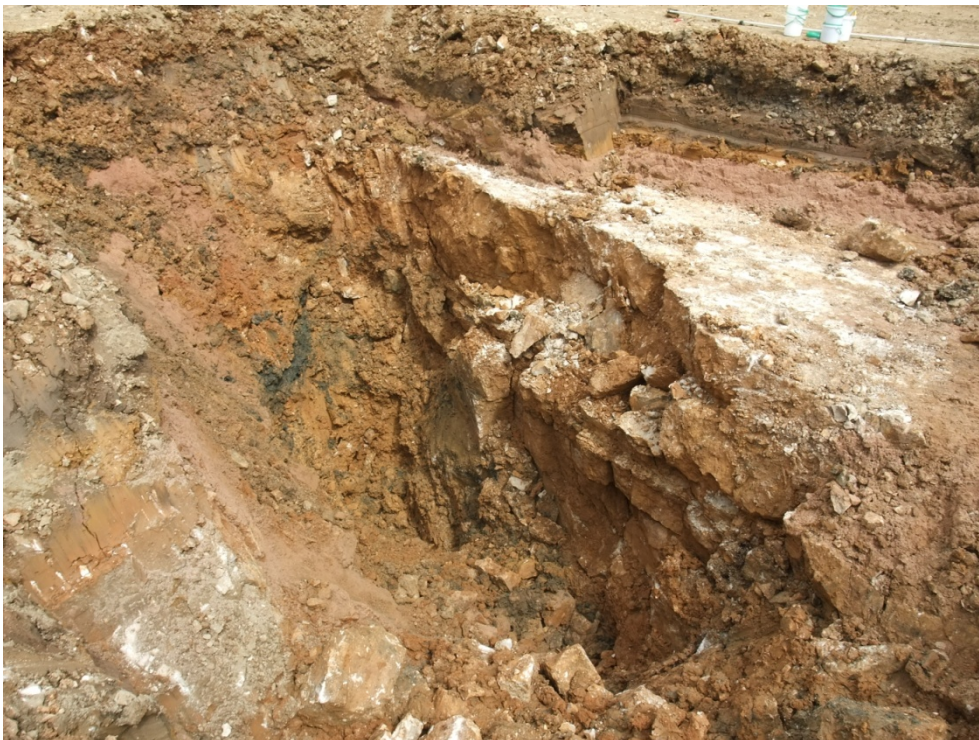
Bild 21: Verlängerung des Schurfs nach Norden: dunkles Material im Einsturztrichter im direkten Kontakt zu geklüfteten Kalkstein
