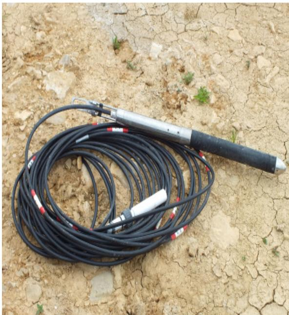
**Abb. 3\_3:** Sparker (seismische Quelle)
