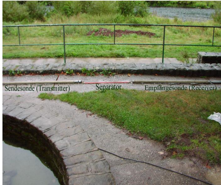
**Abb. 3\_9:** 100 MHz-Bohrloch-Radar-Sonden in Reflexionskonfiguration
