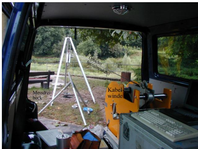
**Abb. 3\_10:** Bohrloch-Radar-Reflexionsmessung unter Nutzung einer Kabelwinde
