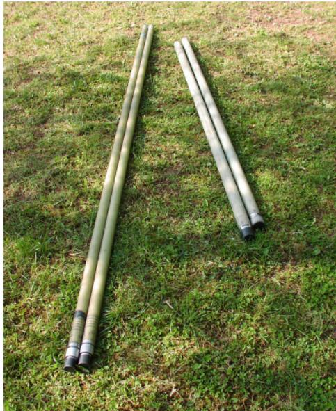
**Abb. 3\_8:** 22 MHz- (links) und 100 MHz- (rechts) Bohrloch-Radar-Antennensonden
