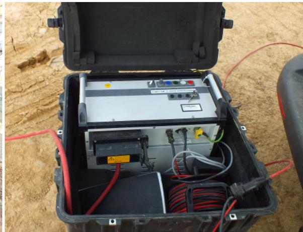
**Abb. 3\_2:** Hochspannungseinheit für Betrieb des Sparkers
