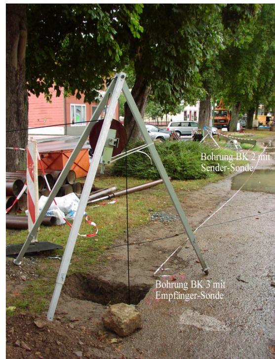
**Abb. 3\_11:** Bohrloch-Radar-Messung im Cross-hole-Modus zwischen zwei Bohrungen (BK 2 und BK 3)
