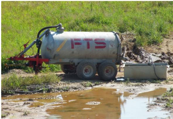
**Abb. 3\_6:** Wasserwagen zum Befüllen der Bohrungen
