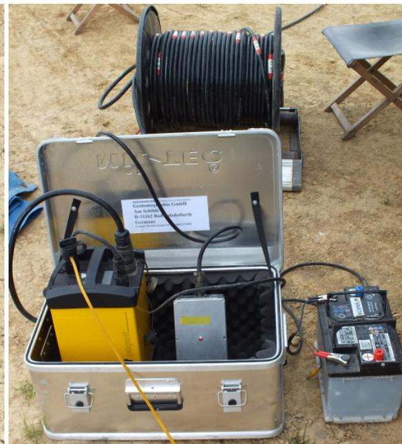
**Abb. 4\_4:** Seismische Registriereinheit
