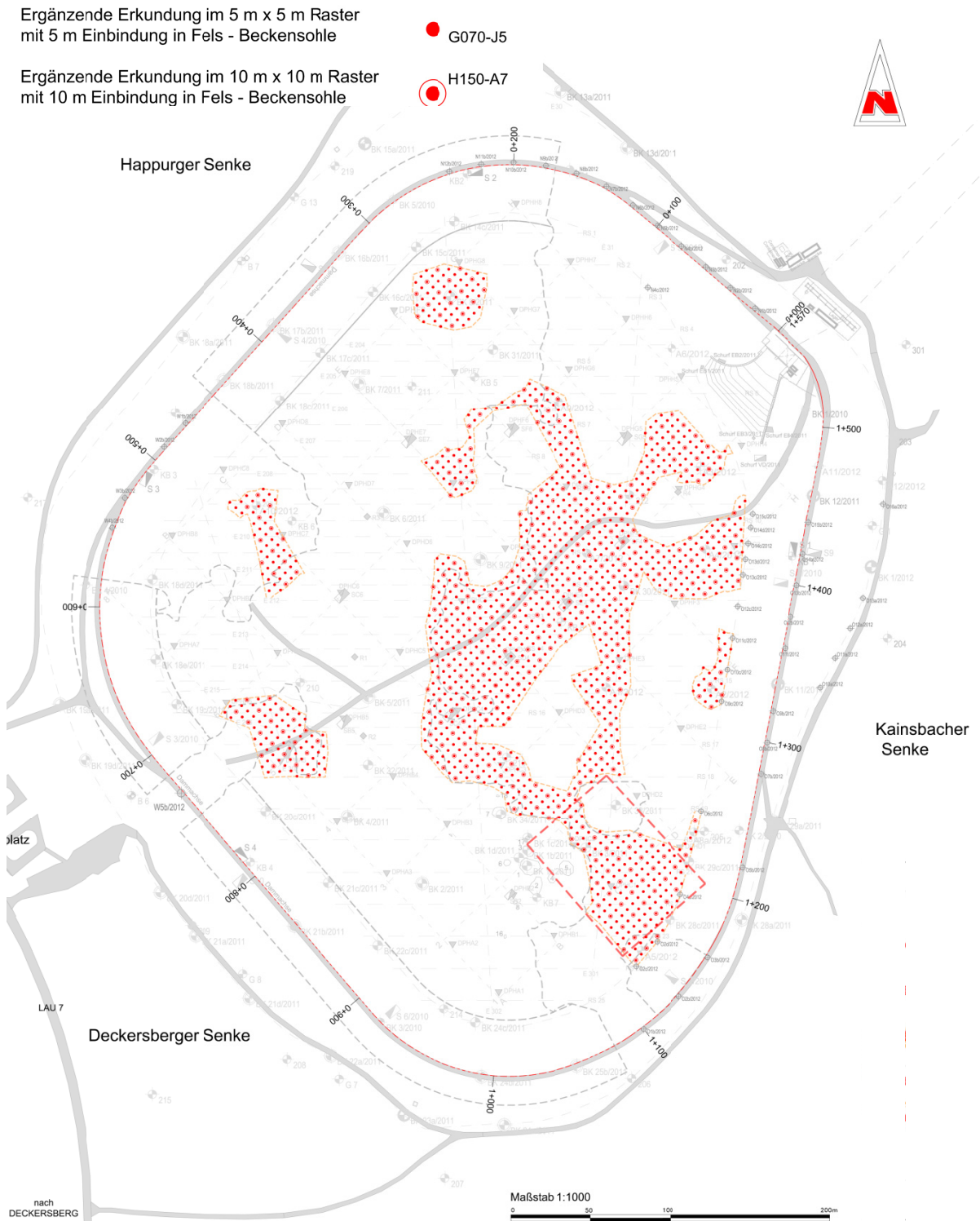
Bild 3a Geplante ergänzende Erkundung mittels rasterförmig angeordneten Bohrungen der Beckensohle außerhalb der Versturzzone mittels rasterförmig angeordneten Bohrungen
