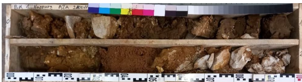
Abbildung 22: Bohrkernabschnitt - Sohldichtung aus der Erkundungsbohrung BK 1/2021 (0m bis 2m)
